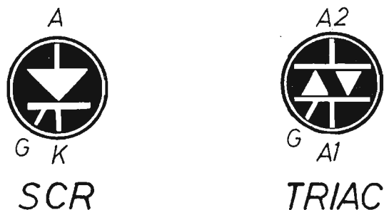
Fig. 4 - A sinistra è riportato il simbolo elettrico dell'SCR, a destra quello del TRIAC. Il primo è caratterizzato dalla presenza di anodo, catodo e gate, il secondo da anodo 1, anodo 2 e gate.
